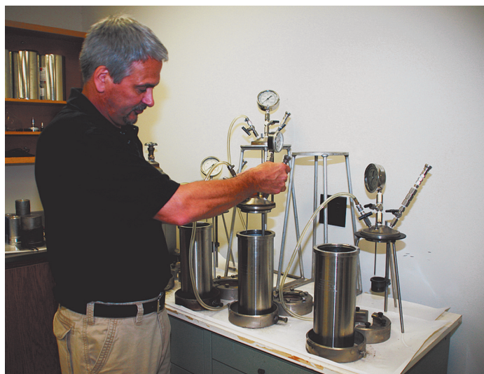
写真 1. アメリカ合衆国ジョージア大学で使用されている高圧反応容器。 反応容器内部に試料を入れる小型の容器 (26) は写真の右下方に見られる。
